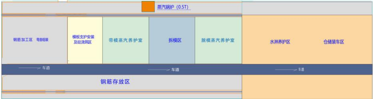
图1 箱涵厂移动式台座生产流水线平面布置图
