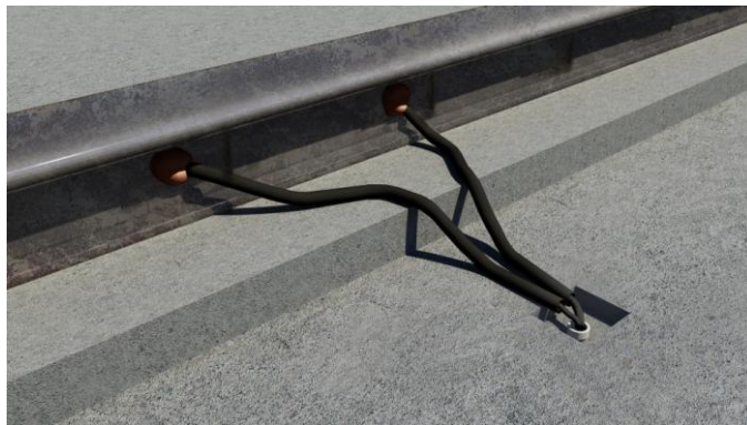
图 4-1 门式起重机轨道防雷接地
